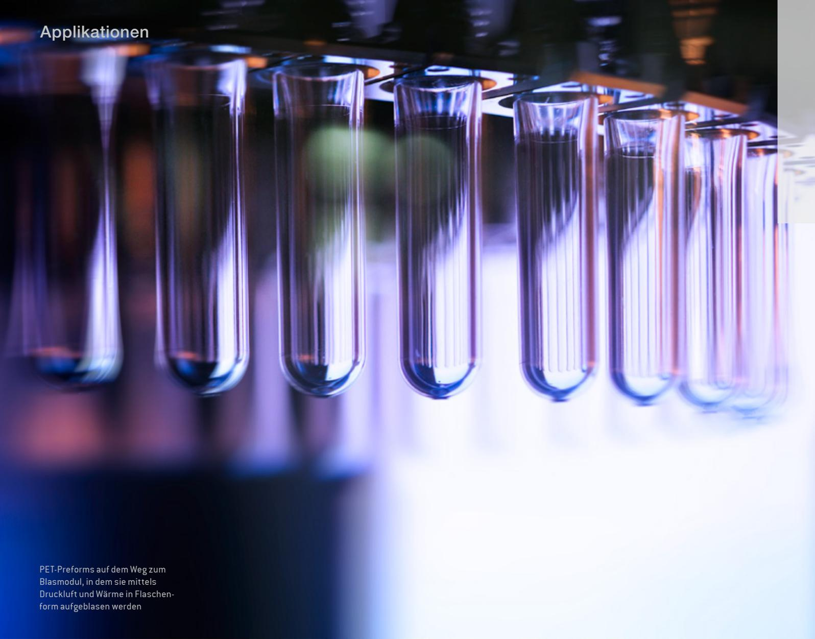
PET-Preforms auf dem Weg zum Blasmodul, in dem sie mittels Druckluft und Wärme in Flaschenform aufgeblasen werden
